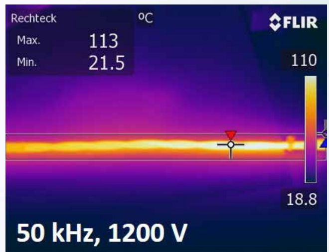
Temperaturbild einer Wicklungsisolierung bei pulsformiger Beanspruchung
