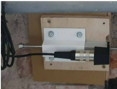
Bild 2 Anwendungen der Additive Fertigung im Bestand, Einbau einer Hilfskonstruktion (in weiß) zur Montage eines Messsystems
