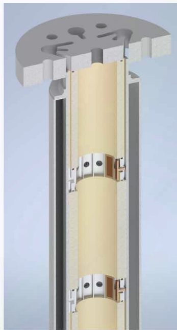
Bild 2: a) Messzelle zur Katalysatorcharakterisierung in reduzierender Atmosphäre, b) Modularer Reaktoraufbau mit zwei positionierbaren ECT-Messebenen (CAD-Schnittmodell), c) gefertigter Prototyp.
