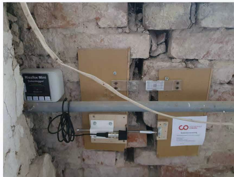
Bild 2 Anwendungen der Additive Fertigung im Bestand, Einbau einer Hilfskonstruktion (in weiß) zur Montage eines Messsystems
