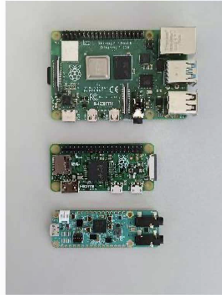
Skalierbare Hardware zur Datenvorverarbeitung und Datenanalyse (Mikrocontroller und Einplatinenrechner)
