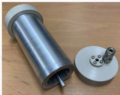
Bild 2: a) Messzelle zur Katalysatorcharakterisierung in reduzierender Atmosphäre, b) Modularer Reaktoraufbau mit zwei positionierbaren ECT-Messebenen (CAD-Schnittmodell), c) gefertigter Prototyp.
