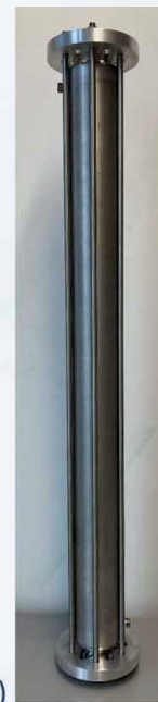
Bild 2: a) Messzelle zur Katalysatorcharakterisierung in reduzierender Atmosphäre, b) Modularer Reaktoraufbau mit zwei positionierbaren ECT-Messebenen (CAD-Schnittmodell), c) gefertigter Prototyp.
